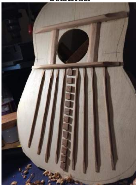
Imagen 3. Tapa armónica construida con base a una chachalaca tradicional
